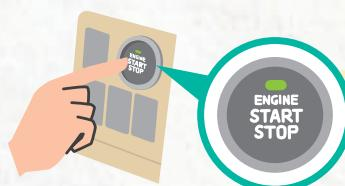
ブレーキペダルを踏まずにエンジンスイッチを押すと次のようにモードが切り替わります。
